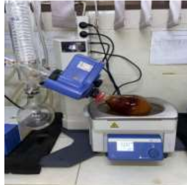
Proses Pemekatan dengan Rotary Evaporator
