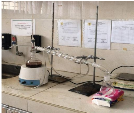
Pemasangan alat destilasi sebelum proses dimulai
