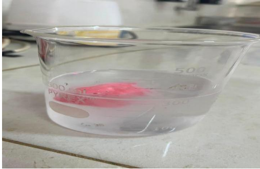
Foto 1. Pengujian daya leleh es krim pada suhu pengujian 60°C.
