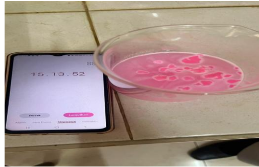
Foto 2. Pencatatan waktu selama proses pengujian daya leleh.
