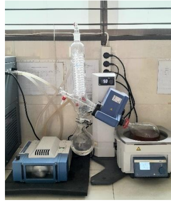
Proses Pemekatan dengan Rotary Evaporator
