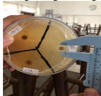
Pengukuran Hasil Zona Bening Dengan Jangka Sorong
